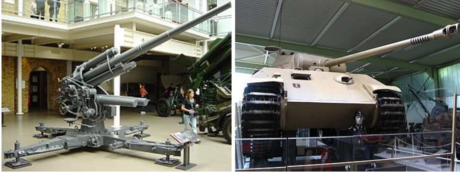
Algunas de las armas de Rheinmetall , a la izquierda el famoso cañón de 88 mm, a la derecha el cañón de 7,5 cm KwK 42 (L/70) que armaba el carro de combate Panther.
